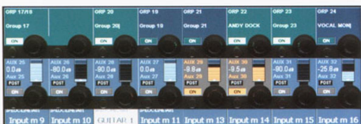
在每个输入通道的母线调整中，可以控制通道送往母线的电平大小和开关状态，或改变推子前后状态。此外，还可以选择在EQ前或EQ后。
