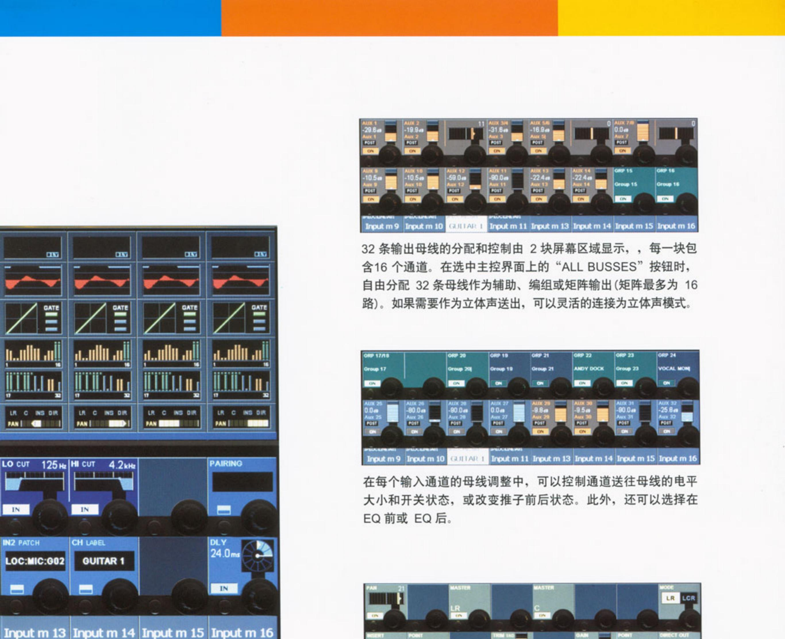
32条输出母线的分配和控制由2块屏幕区域显示，，每一块包含16个通道。在选中主控界面上的“ALL BUSSES”按钮时，自由分配32条母线作为辅助、编组或矩阵输出(矩阵最多为16路)。如果需要作为立体声送出，可以灵活的连接为立体声模式。
