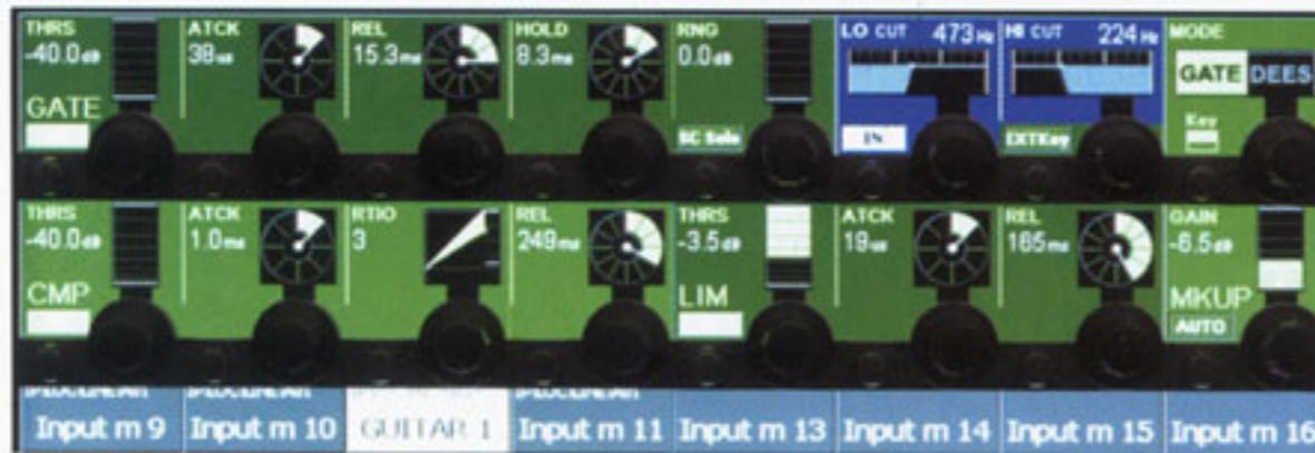
信号动态处理部分包括：噪声门、可控制启动、保持和释放时间、并且能够通过其他通道(Key)来触发。噪声门可以转换为咝声消除器，压缩限幅器可调整门限电平、压缩比和释放时间及总增益调整。同时在推子上方的 LED 电平表上可以显示压缩器的电平衰减。
